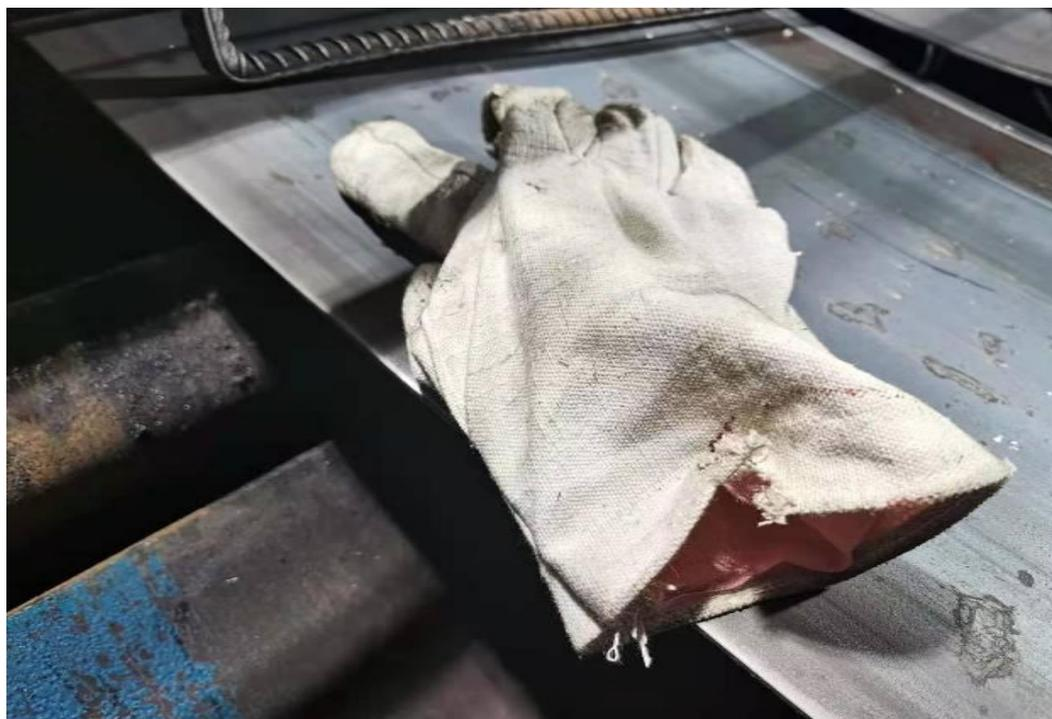
6、从纵剪操作工刘春花笔录中了解到，纵剪机当时运行速度是 64m/min，急停拍下后带钢滑行约 3-4m 停止。在张力辊出料口至卷取机之间第一条带钢与第二条带钢切口处有连续长达 3-4 米的血迹。
