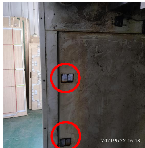
图 9：收纸部光电感应器感应到有障碍物时的屏显示
