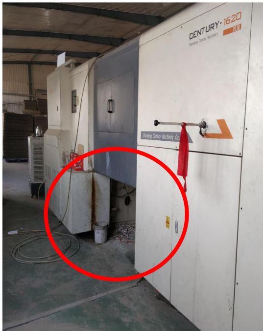
6、图 10：设备右侧切废口 图 11：切废口与收纸口相通
