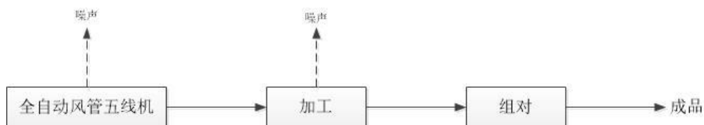
图 11 管道预制生产线工艺流程与污染产生环节
