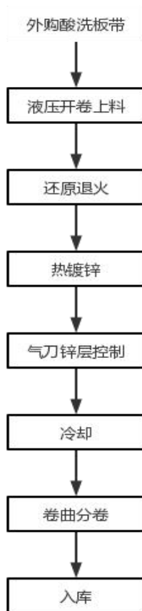
图 2.5-3 热镀锌板带生产工艺流程图
